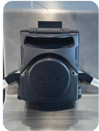
2.c) Gập lẫy của đầu bơm nhu động xuống đóng bộ kẹp ống.
