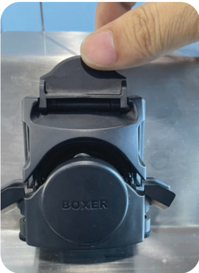
2.a) Mở lẫy phía trên của đầu bơm nhu động để mở bộ ép ống lên.
