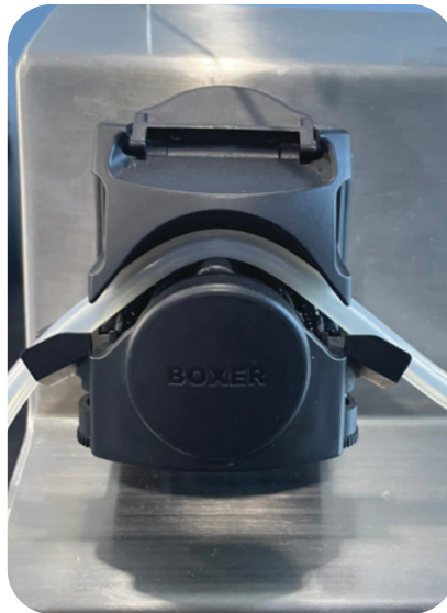
2.b) Luồn ống bơm vào bên trong đầu bơm nhu động.
